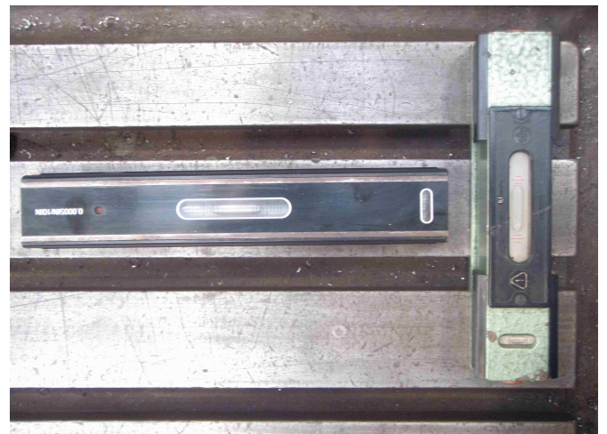
Fuente: P4303014.JPG Esta base auxiliar estuvo perfectamente nivelada
